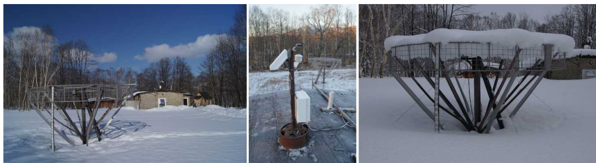
Рисунок 2.53 — Электрометры на обсерватории «Паратунка». Левая панель: специальная опора с датчиком «Поле-2» в центре (впереди – рейка для измерения уровня снежного покрова), на заднем плане – технический павильон с электрометром CS110 на крыше. Средняя панель: электрометр CS110 на специальной опоре на крыше технического павильона, на заднем плане – опора с датчиком «Поле-2». Правая панель: опора и датчик «Поле-2», засыпанные снегом после циклона (23 марта 2016 г.).
