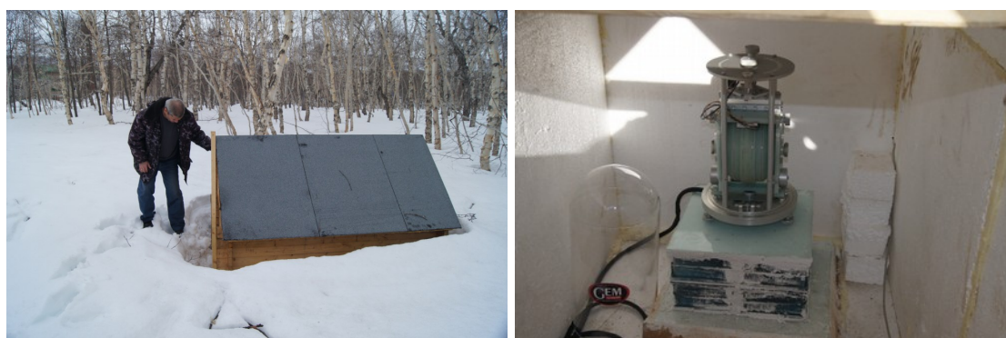
Рис. 51. Магнитометр dIdD GSM-19FD на обсерватории "Паратунка". Левая панель — павильон dIdD (зима), высота стен 1.5 м, вход в павильон - через чердачный лаз. Правая панель - датчик dIdD на постаменте из стеклоблоков, стены и крыша изнутри обклеены пенополистиролом толщиной 10 см. В дальнем правом углу цифровой термодатчик DS18B20.
